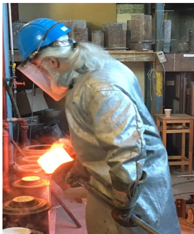
Bronze smeltes til 1100 grader og er klar til støbning
