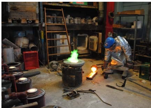
Bronze smeltes til 1100 grader og er klar til støbning
