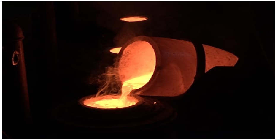
Bronze smeltes til 1100 grader og er klar til støbning
