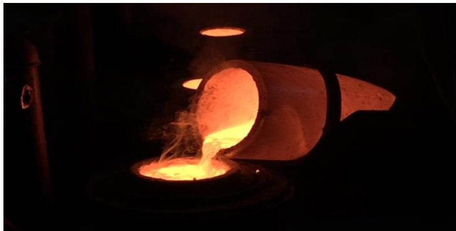
Bronzen varmes op til 1100 grader og er klar til støbning
