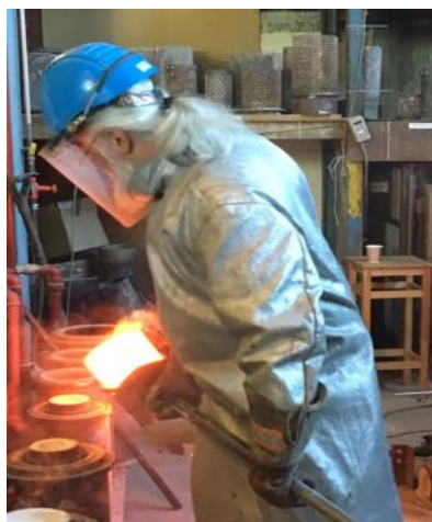
Bronzen varmes op til 1100 grader og er klar til støbning
