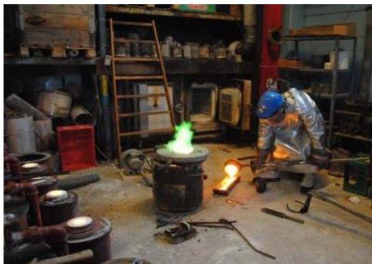
Bronzen varmes op til 1100 grader og er klar til støbning
